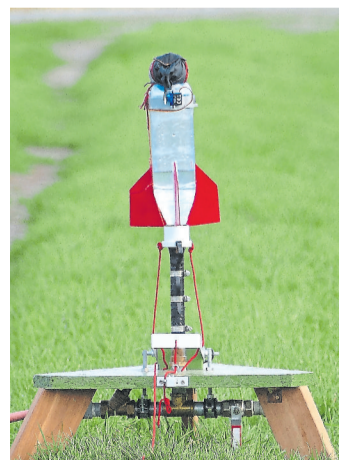
Sven Massing und Jonas Reher haben ein automatisch auslösendes Fallschirmsystem für Wasserraketen gebaut. DZ-Foto: privat
